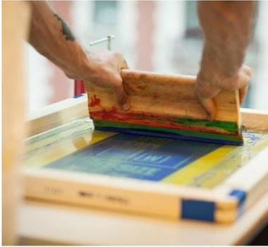
Usando-se uma espátula sem pontas agudas ou cortantes, coloca-se um pouco de tinta no lado em que fica a garra (suporte). Use o bom senso ao determinar "um pouco" de tinta.
