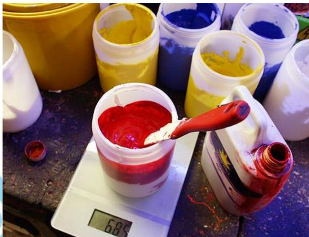
Cada fabricante pesquisa e desenvolve matérias-primas específicas para que as tintas tenham todas essas características. Não é nada fácil formular tintas para serigrafia. Em função da grande quantidade de substratos sobre os quais se pode imprimir com serigrafia, a formulação dessas tintas torna-se muito diferente para cada caso, apresentando uma grande variedade e possibilidades. Assim é indispensável um conhecimento mínimo de como utilizá-las no desenvolvimento do trabalho serigráfico.
