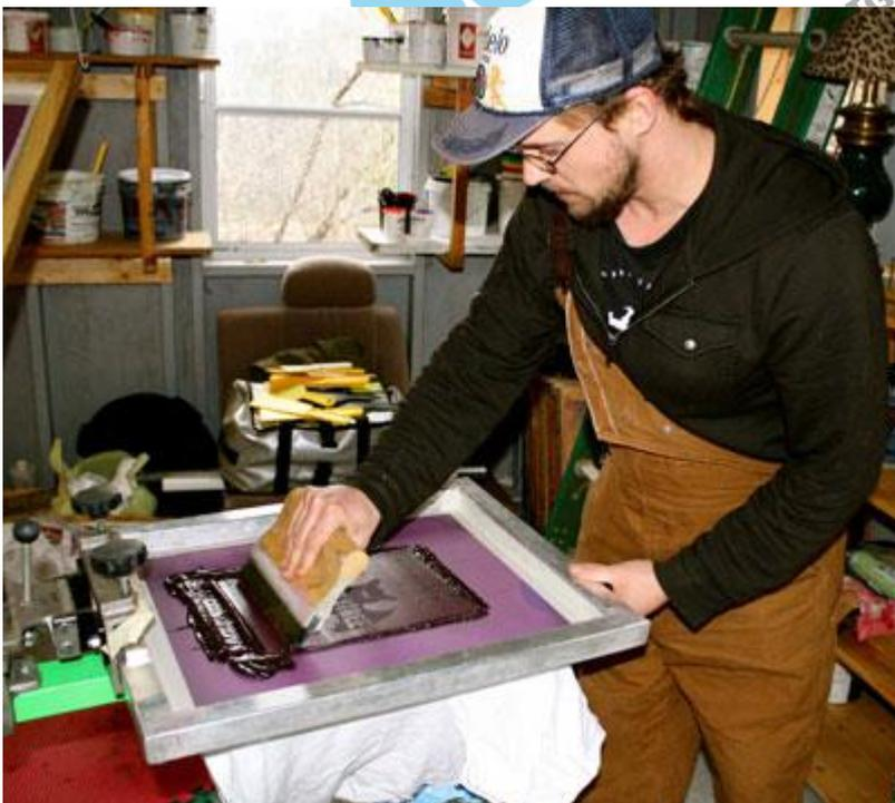
Coloque o material desejado no local marcado na base da mesa. Baixe a tela e puxe em sua direção. Note que ao passar o rodo, puxando a tinta em sua direção, o poliéster da tela cedeu, e por ele, nas partes onde não tem emulsão, passou a tinta, fazendo assim a impressão.
