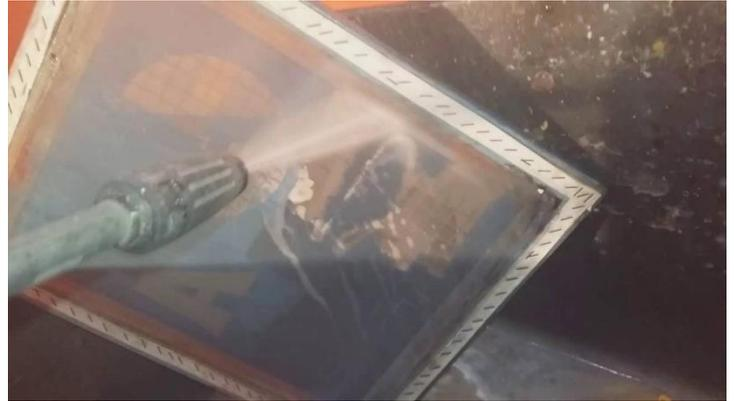
poliéster. Depois que a emulsão amolecer, basta retirar a tela do tanque e jogar água com bastante pressão. Será possível notar que a emulsão começa a se desprender do poliéster. Se em alguns pontos a emulsão insistirem em não soltar, você deverá utilizar duas estopas embebidas em álcool ou em solvente e esfregar. Depois passe a mangueira com jatos de água até a tela ficar completamente livre da emulsão.
